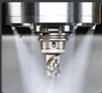
Воздух через шпиндельные форсунки
