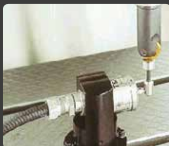
Зондирование инструмента датчиком касания
