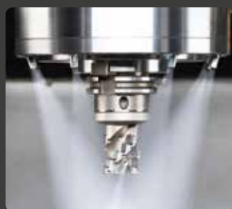
Воздух через шпиндельные форсунки
