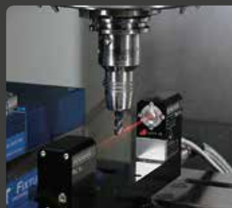
Зондирование инструмента лазерным лучом
