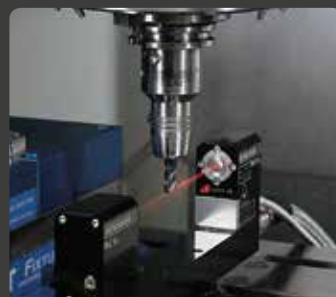
Зондирование инструмента лазерным лучем
