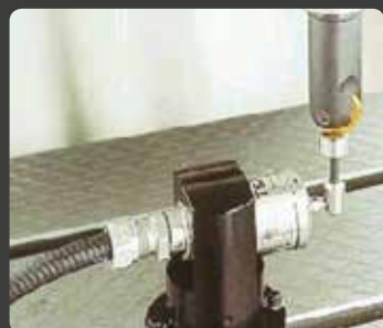
Зондирование инструмента датчиком касания
