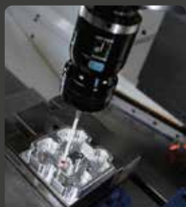
Зондирование детали датчиком касания
