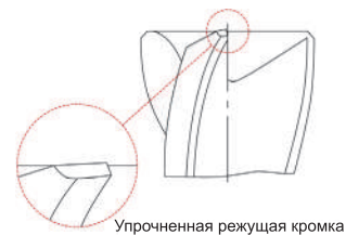
Упрочненная режущая кромка
