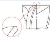
Упрочненная режущая кромка
