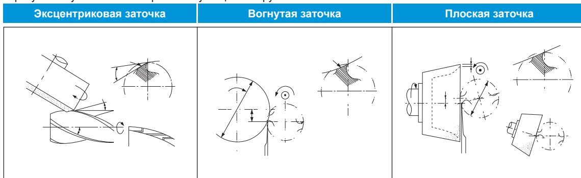
Рис. 3. Три способа заточки главного заднего угла
