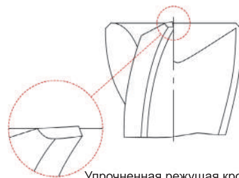
Упрочненная режущая кромка
