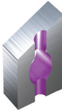
Сверление пересекающихся отверстий
