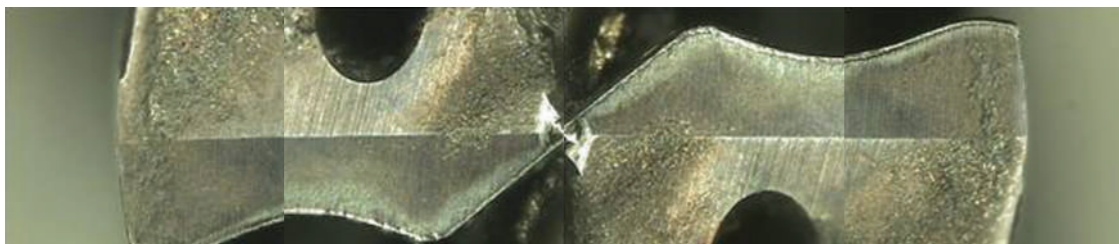
Сверло производителя А (после 546 отверстий)
