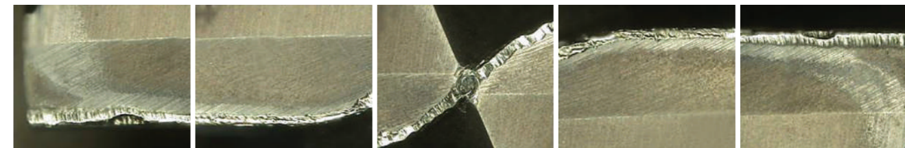
Сверло производителя А (после 40 отверстий)
